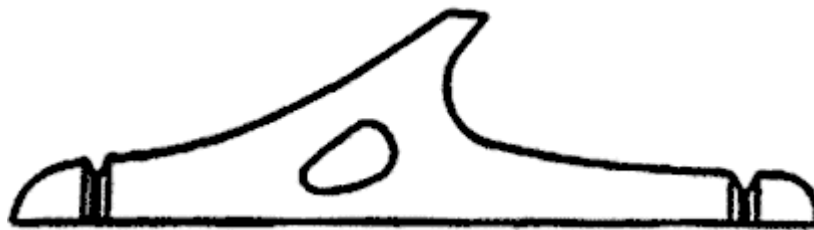
Рис. 33. Уключина, вырезанная из сучка-вилки.
