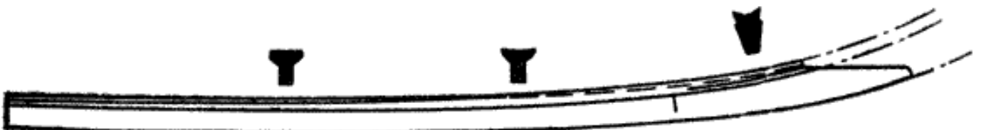
Рис. 37. Часть киля с горизонтальной накладкой для крепления штевня.
